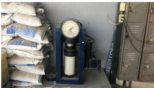
Figura 21. Prueba a compresión simple de la mezcla d (0% - 100%) 28 días
