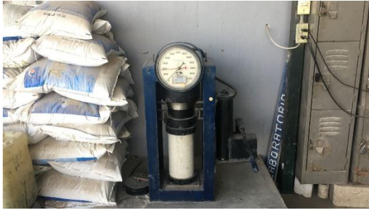
Figura 18. Prueba a compresión simple de la mezcla c (33% - 66%) 28 días
