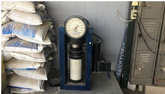
Figura 20. Prueba a compresión simple de la mezcla d (0% - 100%) 14 días
