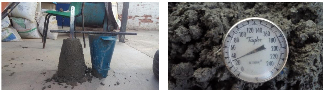
Figura 6. Prueba de revenimiento y temperatura de la mezcla (a) 100% - 0%
