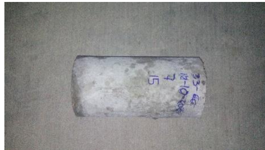
Figura 16. Prueba a compresión simple de la mezcla c (33% - 66%) 7 días
