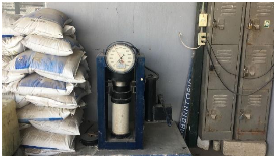
Figura 12. Prueba a compresión simple de la mezcla a (100% - 0%) 28 días
