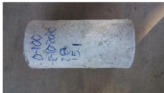
Figura 21. Prueba a compresión simple de la mezcla d (0% - 100%) 28 días
