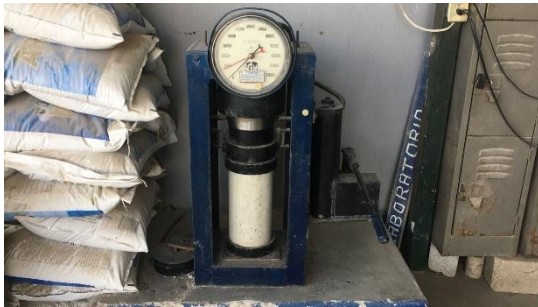
Figura 19. Prueba a compresión simple de la mezcla d (0% - 100%) 7 días
