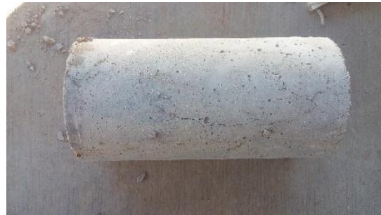
Figura 15. Prueba a compresión simple de la mezcla b (66% - 33%) 28 días
