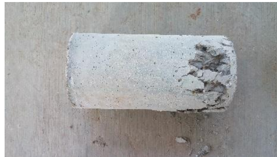
Figura 12. Prueba a compresión simple de la mezcla a (100% - 0%) 28 días
