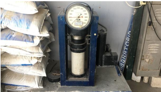
Figura 17. Prueba a compresión simple de la mezcla c (33% - 66%) 14 días
