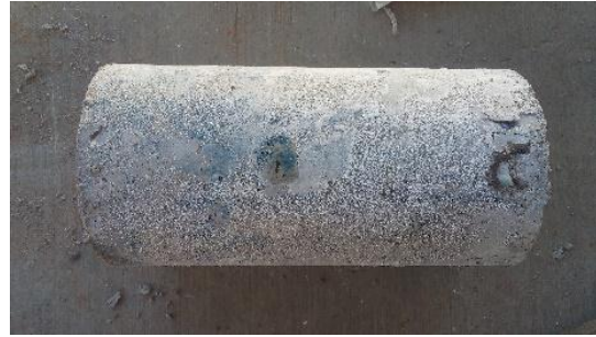
Figura 18. Prueba a compresión simple de la mezcla c (33% - 66%) 28 días
