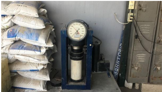
Figura 11. Prueba a compresión simple de la mezcla a (100% - 0%) 14 días
