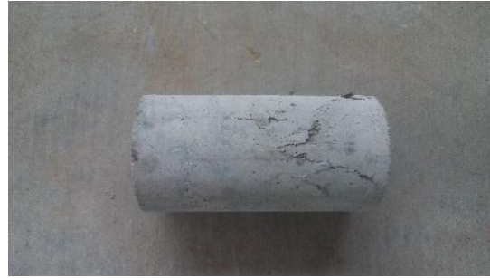
Figura 14. Prueba a compresión simple de la mezcla b (66% - 33%) 14 días
