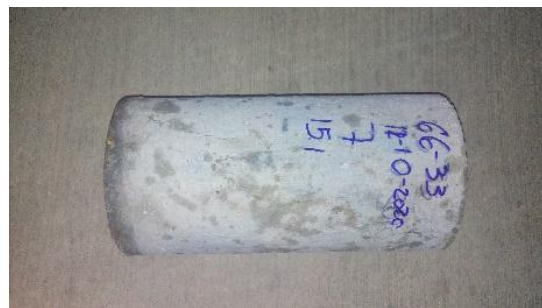
Figura 13. Prueba a compresión simple de la mezcla b (66% - 33%) 7 días
