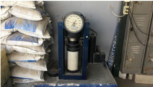
Figura 15. Prueba a compresión simple de la mezcla b (66% - 33%) 28 días
