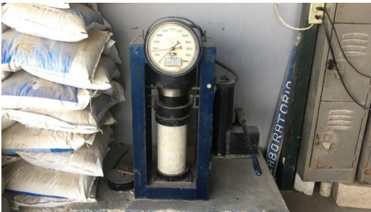
Figura 16. Prueba a compresión simple de la mezcla c (33% - 66%) 7 días
