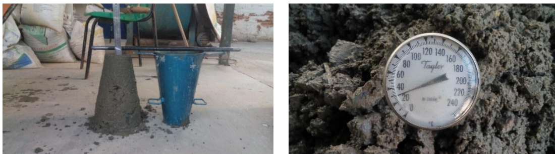
Figura 7. Prueba de revenimiento y temperatura de la mezcla (b) 66% - 33%
