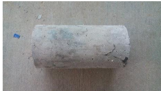
Figura 20. Prueba a compresión simple de la mezcla d (0% - 100%) 14 días
