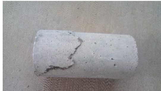
Figura 11. Prueba a compresión simple de la mezcla a (100% - 0%) 14 días
