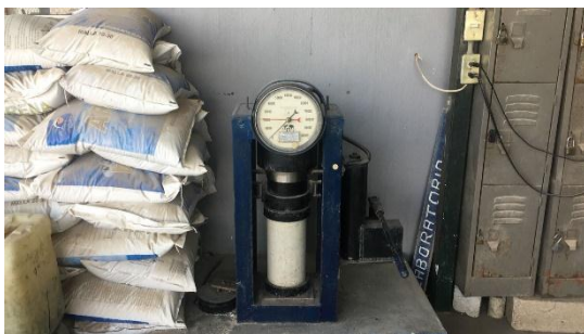
Figura 13. Prueba a compresión simple de la mezcla b (66% - 33%) 7 días
