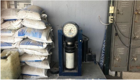
Figura 14. Prueba a compresión simple de la mezcla b (66% - 33%) 14 días
