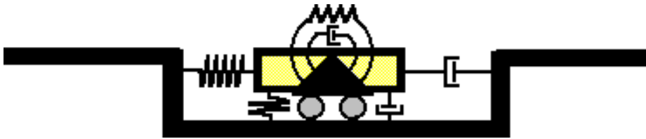
Figura 1. Resortes y amortiguadores equivalentes del suelo
