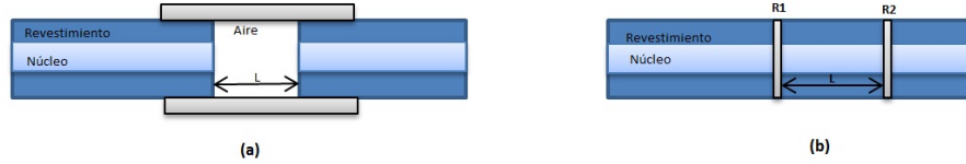
Figura 1.3: (a) sensor extrínseco de FPI formando una cavidad de aire externa, y (b) sensor de FPI intrínseco formado por dos componentes reflectantes, R1 y R2, a lo largo de una fibra.
