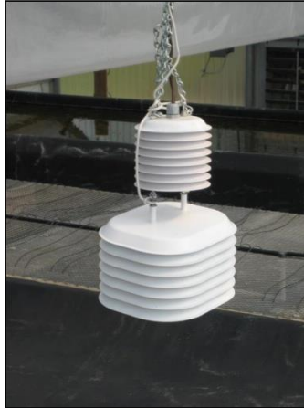
Figura 2. 29 Carcasa para sensor externo, fuente: http://www.onsetcomp.com/
